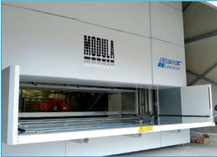
Gestione acciai con magazzino automatico verticale Automatic load system for steels'storage Gestion d'un entrepôt vertical automatique pour l'acier
